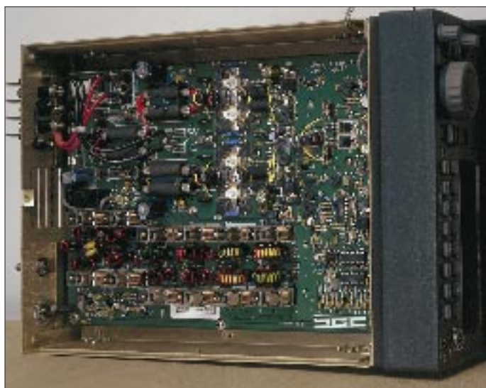
Die Unterseite des Geräteinneren zeigt, wiederum sehr sauber aufgebaut, im wesentlichen die Senderendstufe mit den umschaltbaren Tiefpaßfiltern zur Oberwellenunterdrückung.
