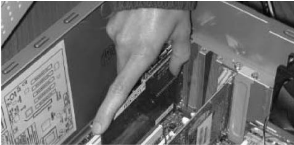
Abb. 2.1: Einsetzen der DVB-Karte in den PCI-Slot
